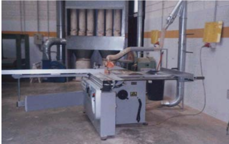
Figura 1. Sierra circular provista de extracción localizada y empujador de piezas
