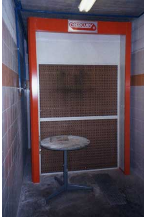
Figura 1. Cabina de pintura
